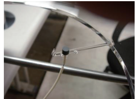
トレータイプ K 熱電対 点接触によりレスポンスが早く長寿命 パイロメータでの測定が不要です。
